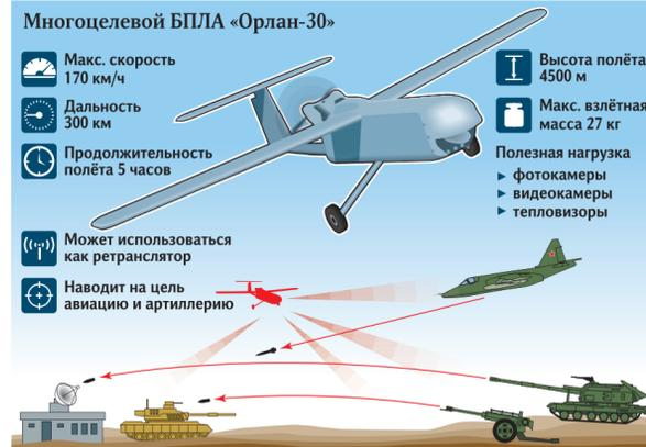
«Краснополь». Полёт этих боеприпасов на конечном участке корректируется с помощью лазерной отметки цели. Незаменим «Орлан-30» и в случае применения корректируемых авиабомб — более дешёвых, чем ракеты, боеприпасов, которые широко использовались в Сирии.
